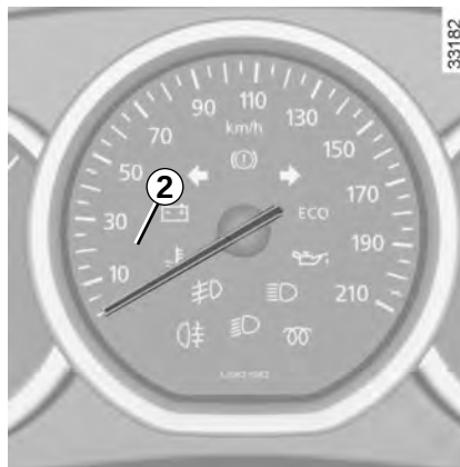
Prędkościomierz 2 (wyskalowany w km/h lub milach/h)
